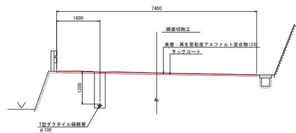
段差すり付け詳細図 S=1/10
